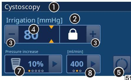
Réglage de la limitation de débit **⑧** (condition requise : paquet logiciel « Advanced » ou VET ART installé) :
