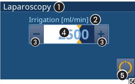
Appuyer sur le bouton Marche/Arrêt ⑤ et laisser la pompe d'irrigation tourner jusqu'à ce que le système de tuyaux soit entièrement déboulé (c'est-à-dire exempt de bulles d'air).
